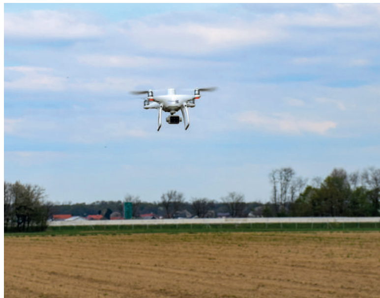
Slika 2: Učenje letenja z dronom, ki ima nameščeno multispektralno kamero, s katero lahko spremljamo stanje posevkov na njivah
