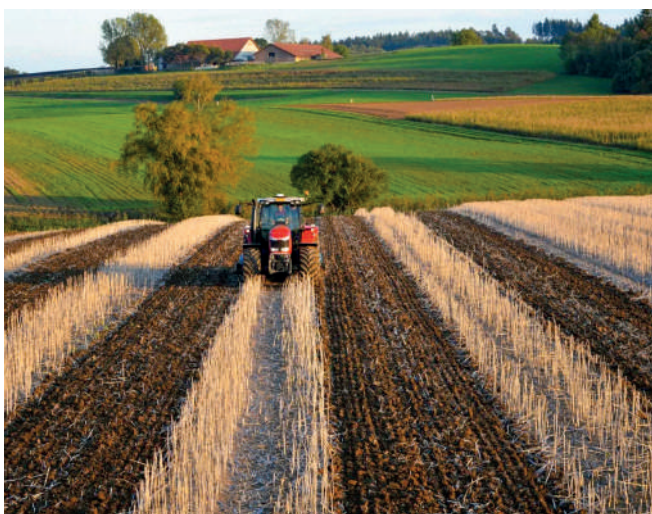
Slika 1: GPS vodi traktorje po virtualno načrtani poti in s tem se zmanjša čas obračanja, prekrivanje prehodov in razbremenijo se vozniki
