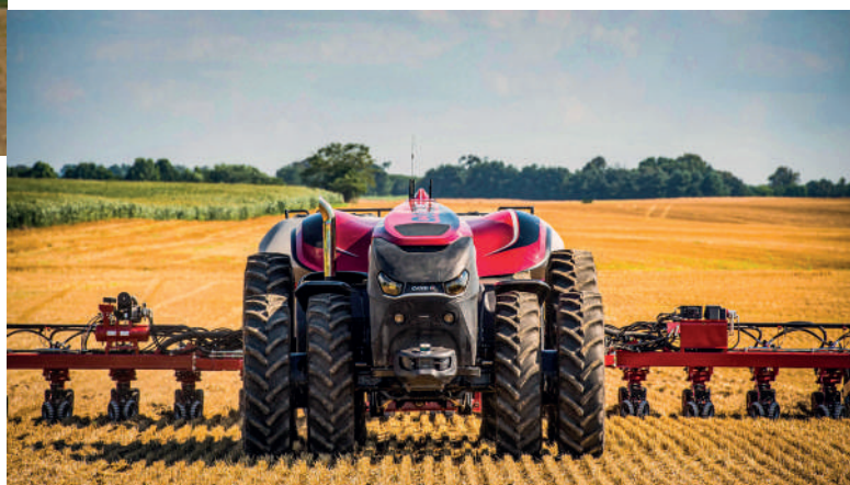
Slika 3: Case-ov koncept avtonomnega traktorja iz leta 2016. Na traktor je nameščenih veliko različnih senzorjev, ki mu omogočajo avtonomno vožnjo po njivi skupaj z zaznavanjem ovir.
