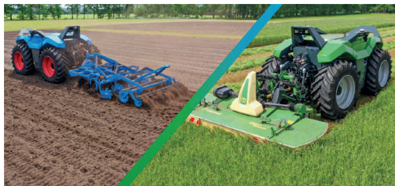
Slika 4: Skupen projekt podjetij Lemken in Krone za avtonomen traktor, ki ga podjetji vidita v uporabi pri obdelavi tal in spravilu krme
