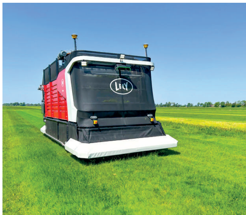
Slika 5: Lely-jev avtonomen robot za košenje sveže trave, ki jo sam pokrmi kravam in jo za sabo pognoji z dušikom.
